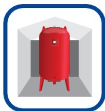
Cuando el tanque esté fuera de servicio por largos periodos, una vez drenado, almacénalo en un lugar seco y con buena ventilación.
