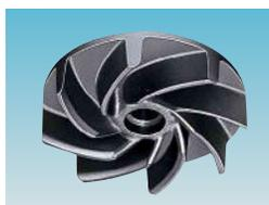
Impulsor de Vórtice, la rotación de este impulsor produce un remolino centrífugo entre el impulsor y la voluta, así creando un espacio entre el mismo y poder bombear solidos y materiales fibrosos, sin tener obstrucciones.
