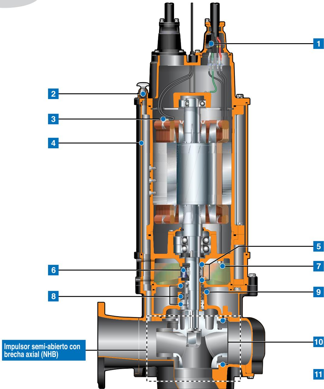
**1 Cable Anti-Torsión** y su recámara cerrada y sellada prevén que la humedad y el agua pueda introducirse, a la bomba aunque el cable se averiara, también previene que la humedad se filtre a la camisa del motor.
