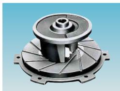
Impulsor con cortador, semi-abierto con dos venas centradas y dos insertos de carburo de tungsteno, las cuales rotan en un plato de succión con dientes así permitiendo cortar cualquier material que pase por la cavidad de succión.
