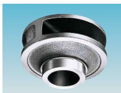
Impulsor cerrado (de canal) viene con una o dos venas, tiene un canal bastante amplio desde la entrada a la salida, el cual permite el paso de solidos con un mínimo bloqueo.
