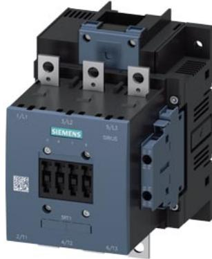
contactor de potencia, AC-3e/AC-3 150 A, 75 kW/400 V AC (50-60 Hz)/DC Uc: 110-127 V tripolar, contactos auxiliares 2 NA + 2 NC accionamiento: convencional circuito ppal.: barra circuito de control y auxiliar: borne de tornillo
