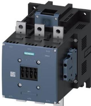
contactor de potencia, AC-3e/AC-3 500 A, 250 kW/400 V AC (50-60 Hz)/DC Uc: 110-127 V tripolar, contactos auxiliares 2 NA + 2 NC accionamiento: convencional circuito ppal.: barra circuito de control y auxiliar: borne de tornillo
