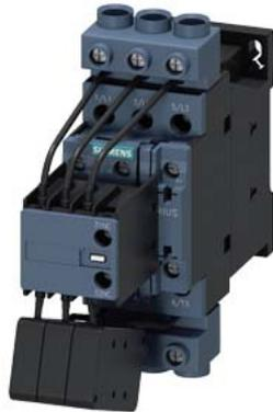
contactor para condensador, AC-6b 33 kVA<sub>r</sub>, /400 V, tripolar, 220 V AC, 50 Hz/240 V, 60 Hz, contactos auxiliares: 1 NA + 2 NC, borne de tornillo, tamaño: S0
