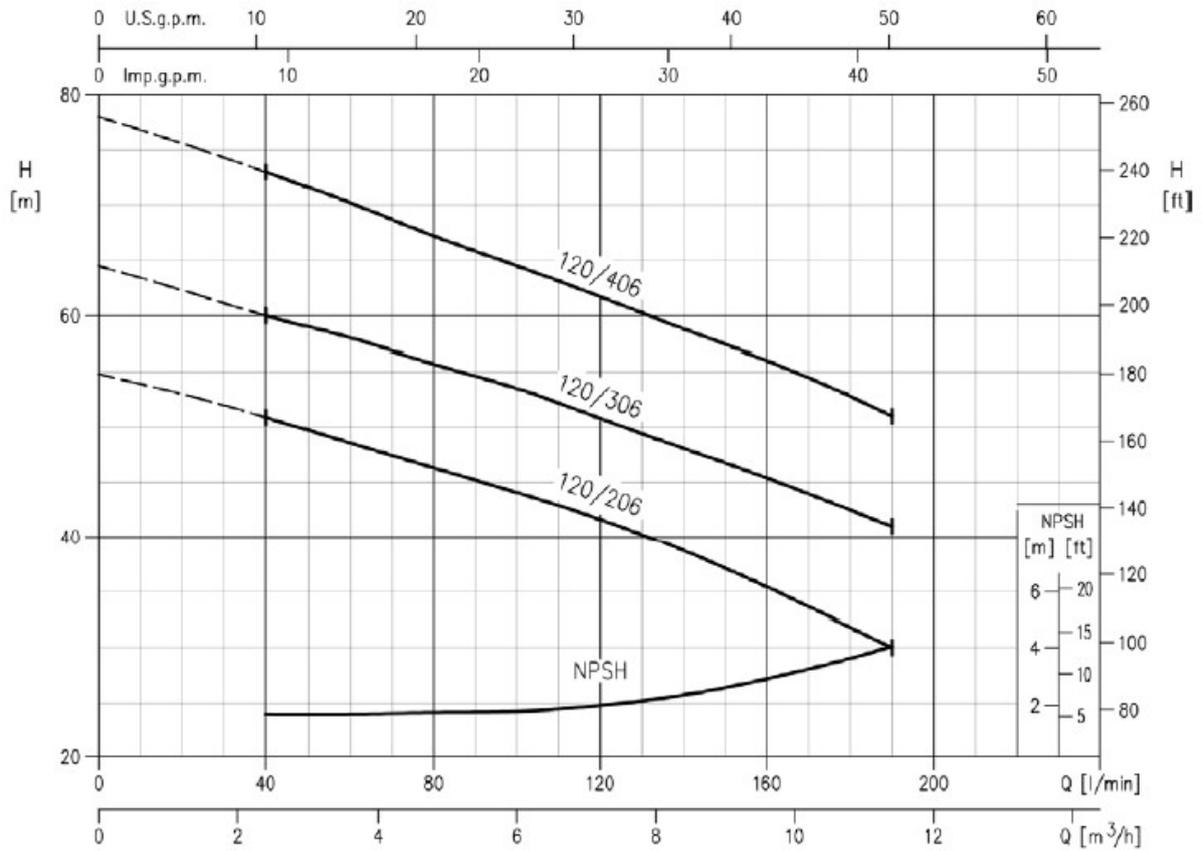
Conformidad según Norma EN ISO 9906:2012 – Grado 3B
